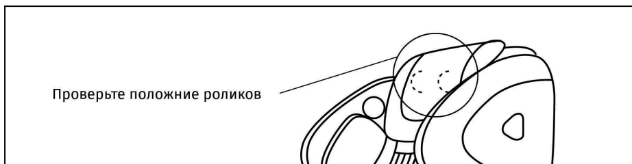
Рисунок 13 — Правильное положение роликов
