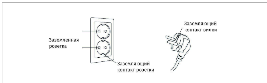
Рисунок 25 — Правильное заземление массажного кресла
