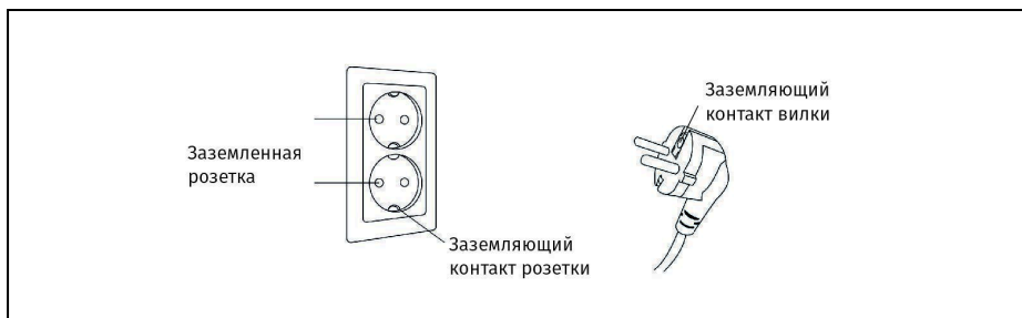
Рисунок 24 — Правильное заземление массажного кресла
