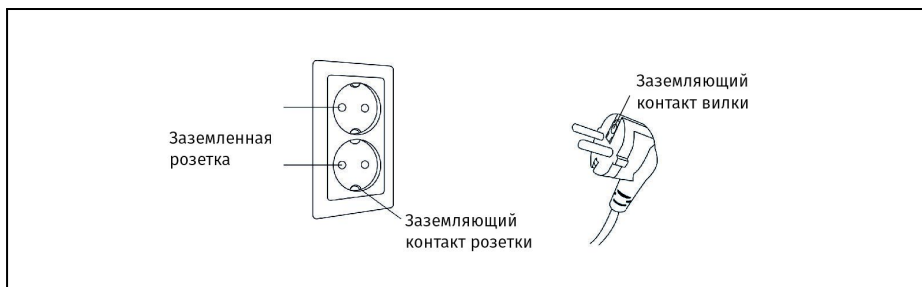
Рисунок 33 — Правильное заземление массажного кресла
