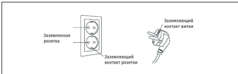
Рисунок 59 — Правильное заземление массажного кресла
